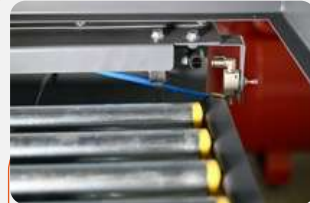
Система за обдухване на фотодатчиците (срещу запрашаване)
